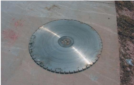
Figura 6 - Disco diamantado para corte de juntas
