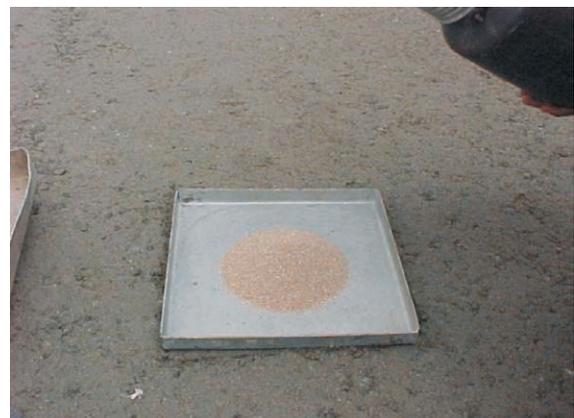
Figura 19 – Quantidade de areia no furo durante o ensaio
