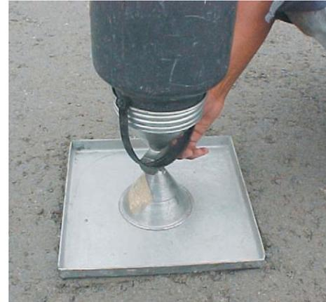
Figura 18 – Ensaio do grau de compactação com frasco de areia
