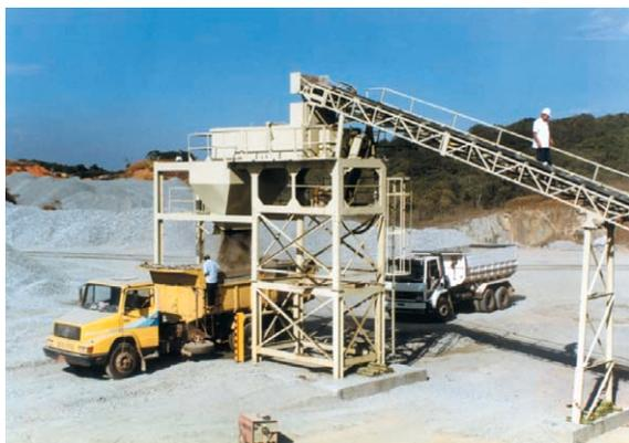
Figura 3 – Transporte por caminhão-basculante
