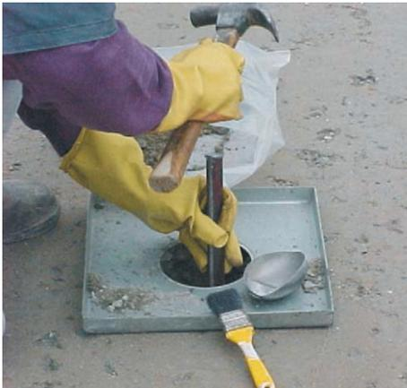
Figura 16 – Abertura do furo para o ensaio do grau de compactação
