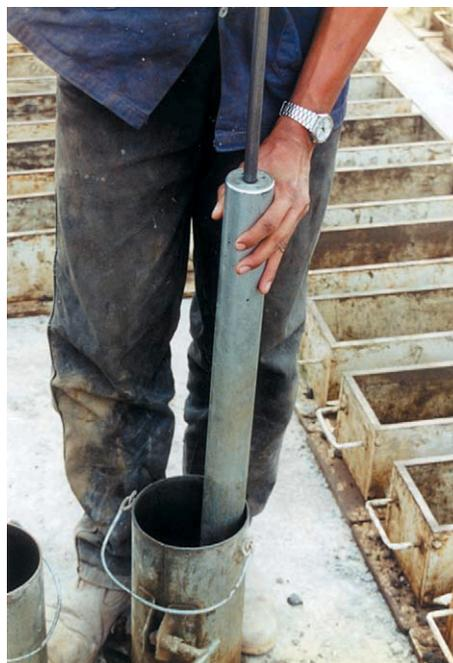
Figura 13 – Moldagem de corpo-de-prova cilíndrico, com soquete de 4,5 kg, na energia normal (após liberação da umidade)
