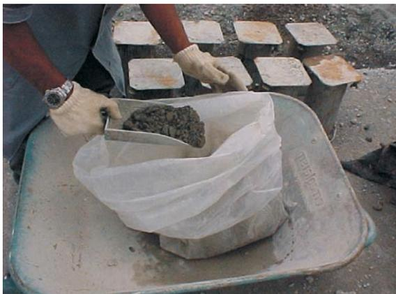
Figura 10 – Após a coleta na pista, corpos-de-prova já moldados e devidamente protegidos
