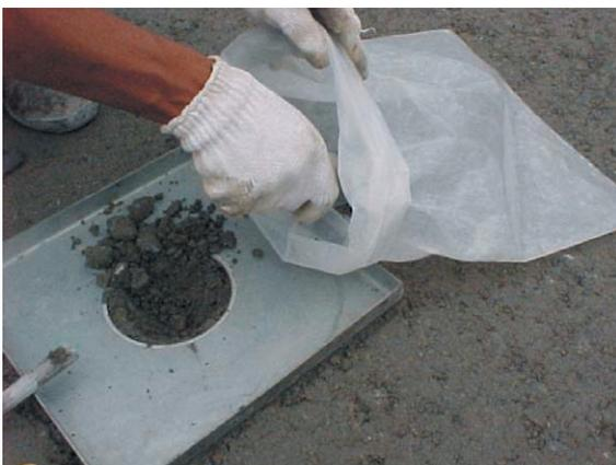
Figura 17 – Coleta do concreto retirado do furo, com os devidos cuidados para não perder material, e acondicionamento em saco plástico
