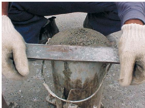
Figura 14 – Acabamento da última camada do corpo-de-prova com régua metálica biselada
