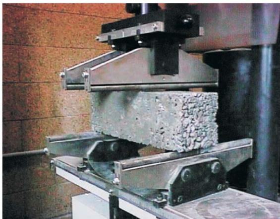
Figura 21 – Ensaio de resistência mecânica (compressão simples e tração na flexão), em prensa computadorizada
