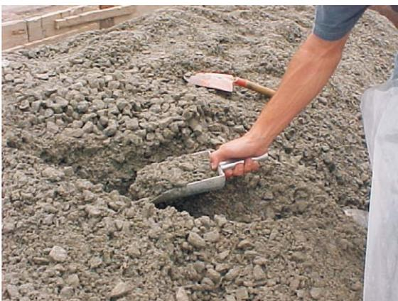
Figura 6 – Seqüência da amostragem no caminhão-basculante, antes do lançamento
