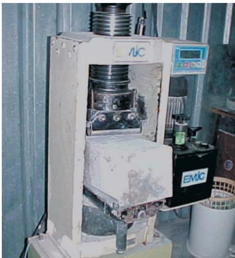
Figura 20 – Ensaio de resistência mecânica em prensa computadorizada
