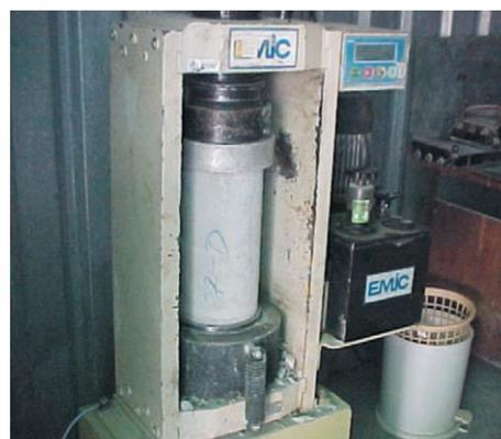
Figura 3 – Verificação da resistência mecânica do concreto
