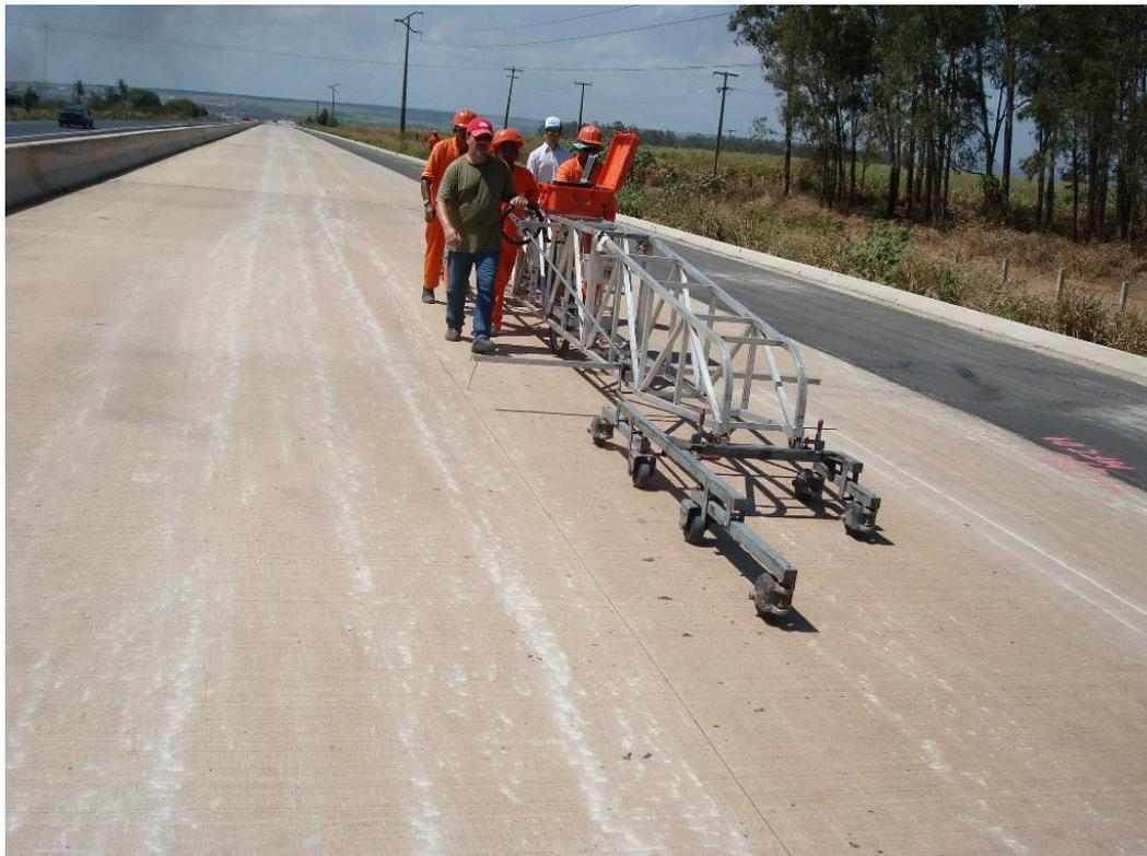
**Operação do perfilógrafo sobre cada faixa de tráfego, nas trilhas de roda externa e interna a uma velocidade máxima de operação igual a 5 km/h**
