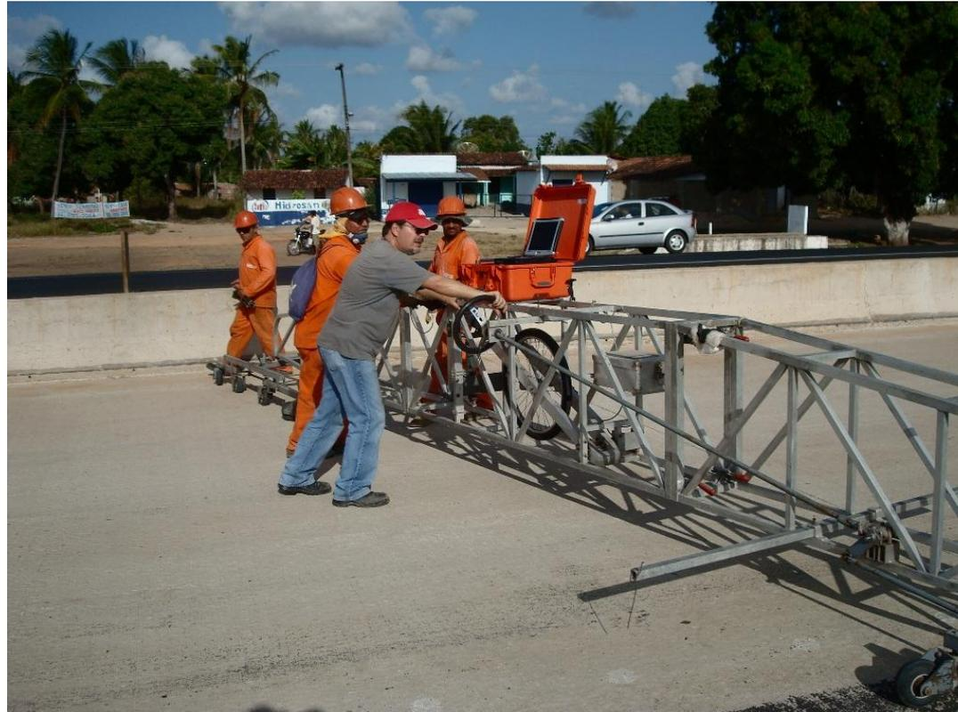
**Equipamento que serve para medir a irregularidade longitudinal de pavimentos de concreto em fase de construção, sendo também o equipamento empregado pela maioria dos Departamentos Estaduais de Transporte (DOT) americanos.**
