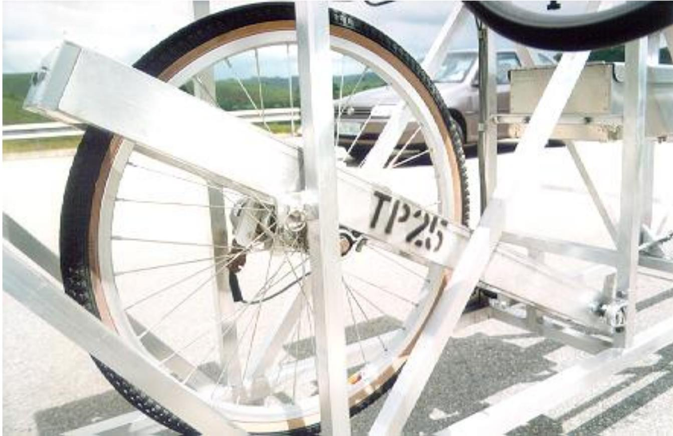
**Dotado de roda sensora, localizada no meio da estrutura, livre para movimentar-se verticalmente**
