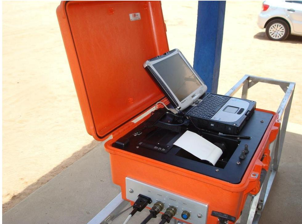
**Os movimentos da roda sensora são captados por um transdutor e um odômetro e enviados a um computador que grava os desvios do plano de referência, traçando o perfil do pavimento**
