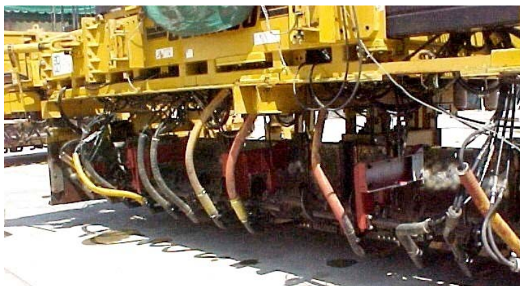
Figura 21 – Bateria de vibradores internos
