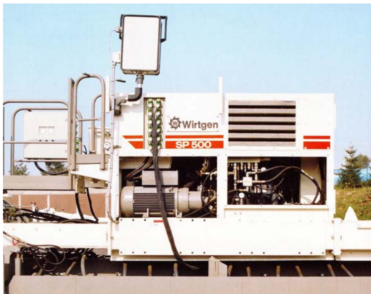
Figura 23 – Conjunto gerador com as tomadas para os vibradores
