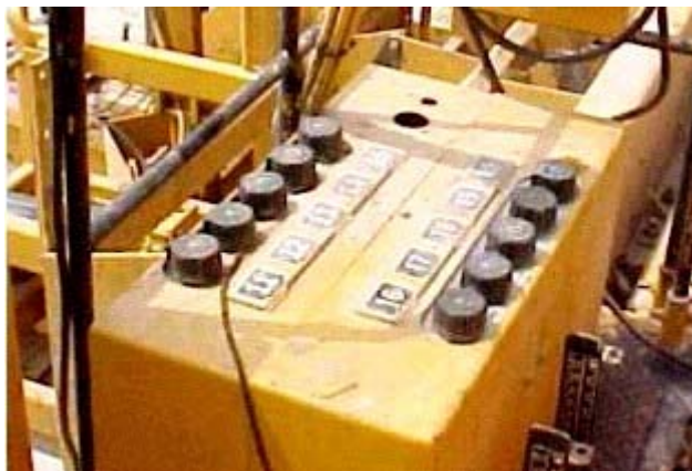
Figura 22 – Painel de controle dos vibradores CMI
