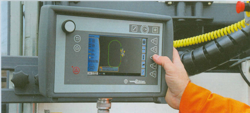
Figura 3 - Trabalhando com perfis de bordas retas ou mesmo com perfis complexos com raios muito estreitos, o piloto automático da Wirtgen conduz a máquina com precisão, proporcionando resultados de alta qualidade.
